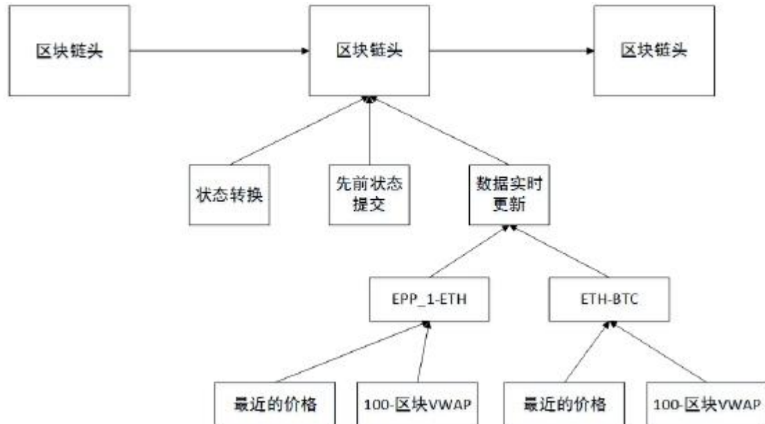
图 2：实时数据的定期提交将在 OmiseGO 区块链中记录。人们可以通过区块头中的 merkle 根提交信息来进行外部验证。交易数据来源包含最近交易价格，交易量和各种 VWAP 条件（各种时间和/或区块数）等常用交易对。
